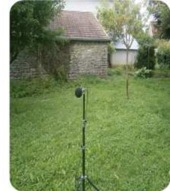
Pose d'un sonomètre
