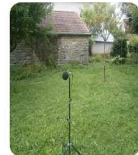
Pose d'un sonomètre
