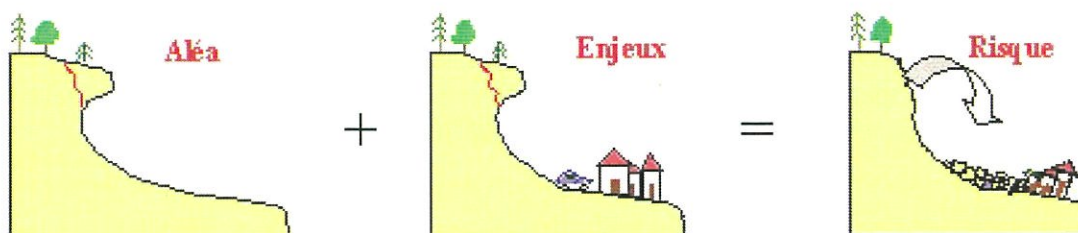
Illustration 1 : Exemple du risque éboulement (source : http://www.urbanisme.gov.pf )
