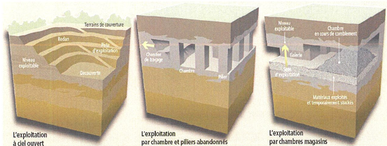
Illustration 22 : Exploitation à ciel ouvert, chambres et piliers abandonnés et en chambres magasins
